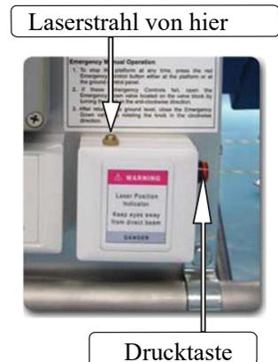
**ACHTUNG:** BEI DER VERWENDUNG DIESER LASERPOSITIONSORTUNG IST VORSICHT GEBOTEN. SCHAUEN SIE NIEMALS IN DEN LASERSTRAHL. Entfernen Sie die Kappe am Auslass, um die Arbeitsstellung zu überprüfen. Setzen Sie die Kappe sofort nach dem Gebrauch wieder auf, um versehentliche Verletzungen der Augen zu vermeiden.
