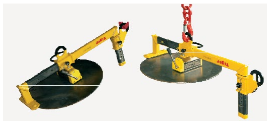
Rys. 27-4 Pozycja: podnoszenie do pionu
