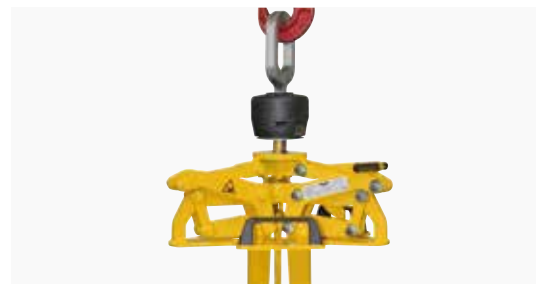
Afb. 5-3 Binnenste grijper met Demag-Manu-koppelingsopname
