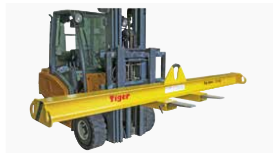
Afb. 25-3 Vorkheftruck met balktraverse
